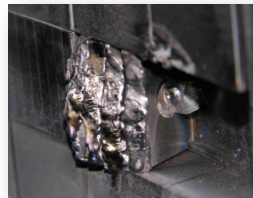
Melted tungsten tile B. Lipschultz, Nucl. Fusion (2012)
