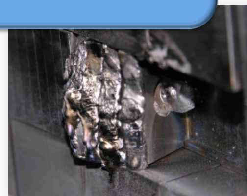
Melted tungsten tile B. Lipschultz, Nucl. Fusion (2012)
