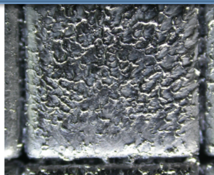
Tungsten tile in fusion device, before & after plasma exposure Z. Hartwig, MIT
