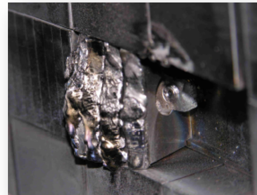
Melted tungsten tile B. Lipschultz, Nucl. Fusion (2012)
